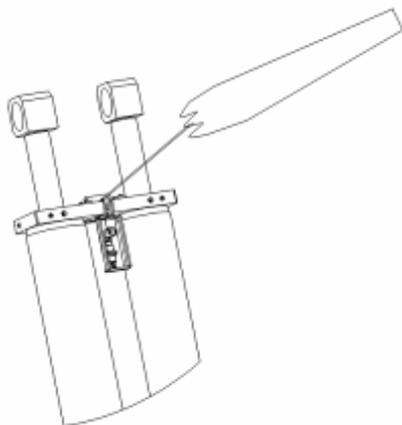
2. Skru løs den innerste delen av solenoide avlesningsventilen, som er festet på den hydrauliske blokken.
