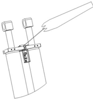
4. Skru løs den innerste delen av solenoide avlesningsventilen, som er festet på den hydrauliske blokken.
