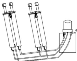
2. Tilkoble den ikke-medfølgende håndpumpen til den hydrauliske blokken, der hvor den avtakbare proppen satt.
