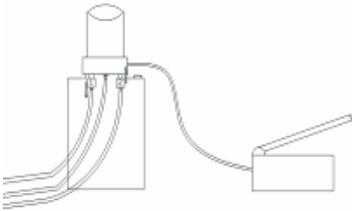
3. Trykk på håndtaket på håndpumpen for å heve plattformen og låse opp sikkerhetstennene. Trekk deretter i sikkerhetstennene med stålwire for å frigjøre sikkerhetslåsen.
