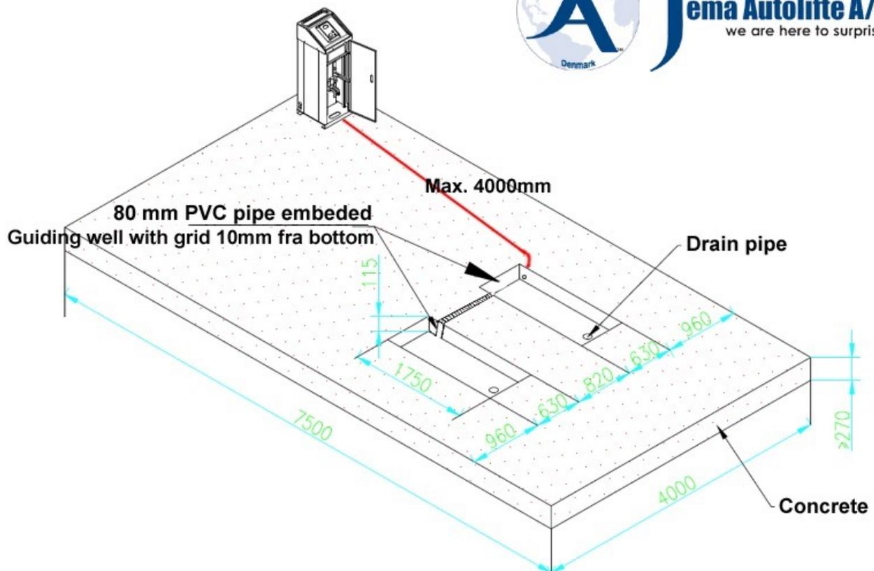
Hydraulikkolje-slangen fra løftebukken til kontrollpanelet er 5000mm lang. Derfor anbefaler vi at panelet plasseres maks 4000 mm unna selve løftebukken.
